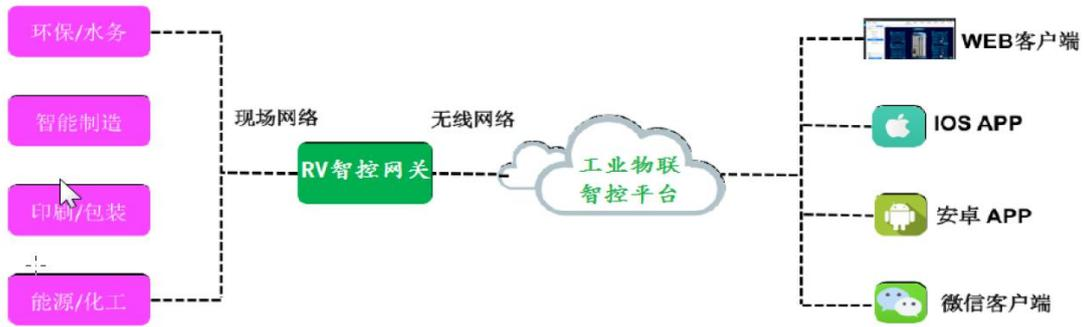
根据项目需求，数据采集端采用支持移动、联通、电信无线通讯的数据采集模块 RVGate，用于采集设备数据并传送至云服务器端，平台采用自主研发的标准化的智慧环保设备管理平台，用于实现数据的远程监控、运营等。
